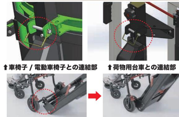
車椅子/台車の背面にある装着部にクローラー部分の軸部をはめ込み、ロックピンを差し込み固定するだけで連結ができます。簡単に着脱ができますが、安全面を重視して走行中に外れるようなことがない設計になっています。
