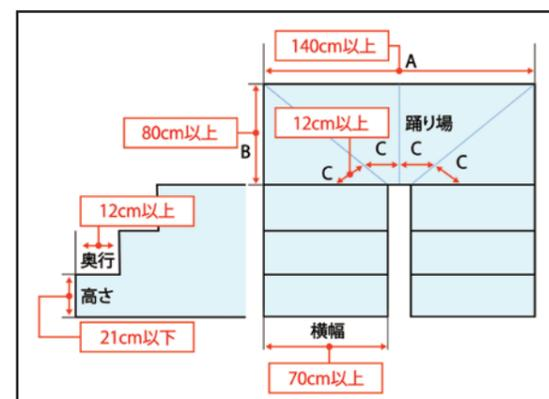
左図面の寸法の階段で使用が可能です。基本的には直線階段に対応しています。(※らせん階段は使用不可、公共住宅やマンションなど踏み場で方向転換が可能な階段は使用可能です) 階段の段鼻(端)を傷めないで、コンクリート・木製・鉄製の階段でも使うことができますが、段鼻(端)の保護のためにステップ取付けを推奨しています。狭い場所での方向転換が容易なため、狭い踏み場でも苦勞しません。使用を想定している階段で利用が可能かどうかを調査いたします。お気軽にお問合せください。(遠方の場合は写真での判断も可能です)
