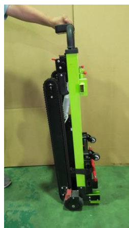
⑦枕をはずしてから赤いレバーを前に押し昇降時ハンドルを下げます。
