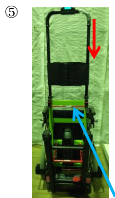
④車椅子を降ろします。⑤赤いパイプを前に押して昇降レバーを下げます。⑥赤いパイプを下へ押しベルトを畳む *このままでも置いてけます。
