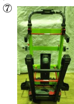
⑦枕をはずしてから赤いレバーを前に押し昇降時ハンドルを下げます。
