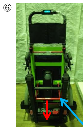
④車椅子を降ろします。⑤赤いパイプを前に押して昇降レバーを下げます。⑥赤いパイプを下へ押しベルトを畳む *このままでも置いてけます。
