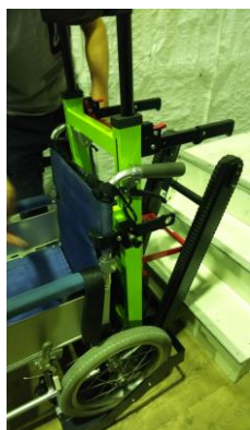
①キャスターをロックします。②赤いノブで固定具を緩めます
