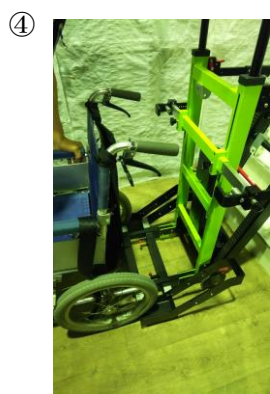
④車椅子を降ろします。⑤赤いパイプを前に押して昇降レバーを下げます。⑥赤いパイプを下へ押しベルトを畳む *このままでも置いてけます。
